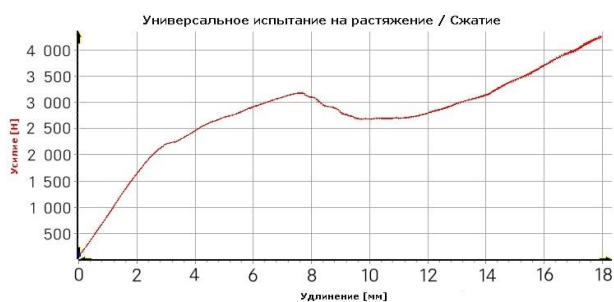
Рис. 16. Кривые упругопластического деформирования композитной трубы на разных участках. Предельная нагрузка 3,2 кН
