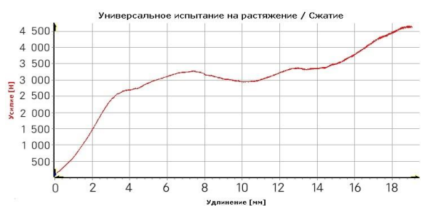
Рис. 14. Кривые упругопластического деформирования композитной трубы на разных участках. Предельная нагрузка 3,3 кН
