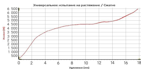
Рис. 15. Кривые упругопластического деформирования композитной трубы на разных участках. Предельная нагрузка 4,5 кН
