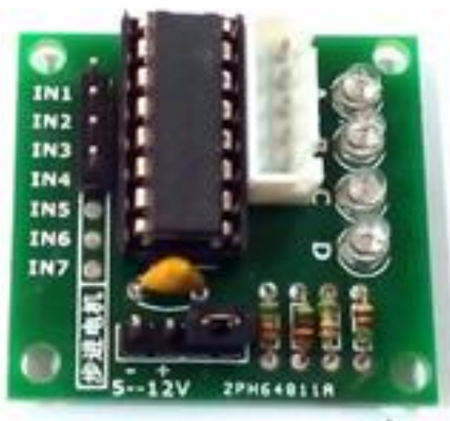
Рис. 3. Драйвер шагового двигателя ULN2003
