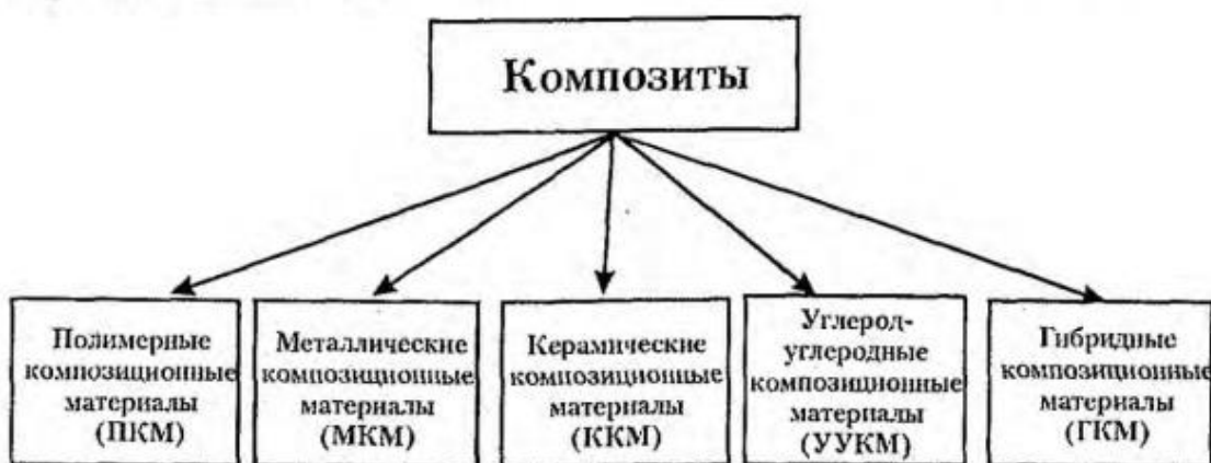
Рис. 1. Классификация композитных материалов по материаловедческому признаку
