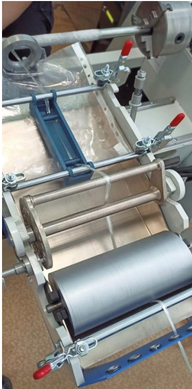
Рис. 9. Устройство для формирования композитных труб методом намотки
